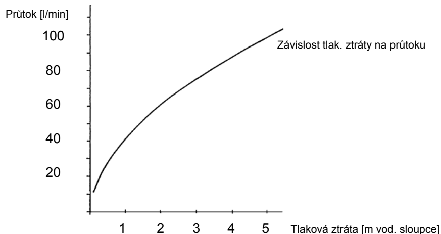
Obr. č. 14 Charakteristika trojcestného ventilu Honeywell V 4044F
