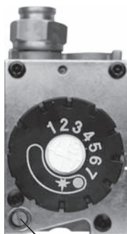
nastavení množství plynu do zapalovacího hořáčku
