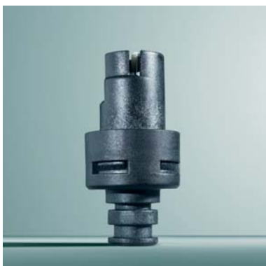
Tlakový senzor neustále kontroluje tlak vody v topném systému a ihned reaguje na pokles tlaku odstavením kotle z provozu s následným chybovým hlášením.
