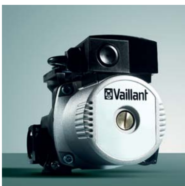
Oběhové čerpadlo s plynulou regulací otáček v závislosti na aktuálním tepelném výkonu. Tím dochází rovněž i ke snížení spotřeby elektrické energie kotle.
