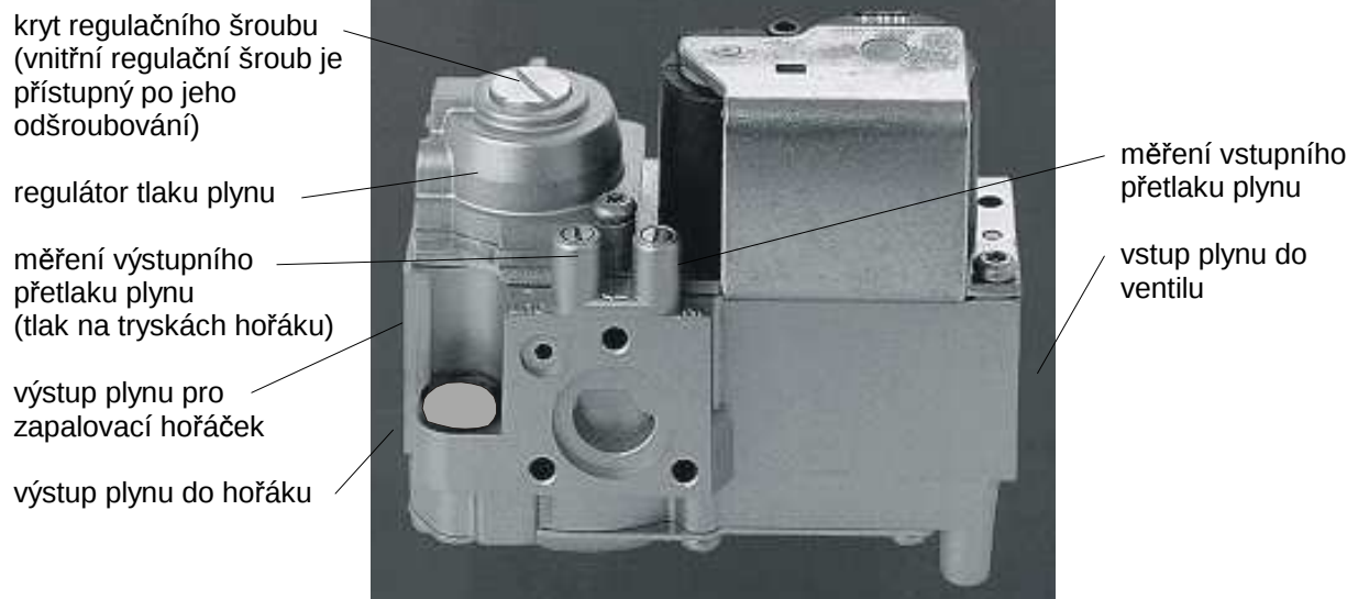
Obr. č. 31 Plynový ventil Honeywell VK 4100 A 1002
